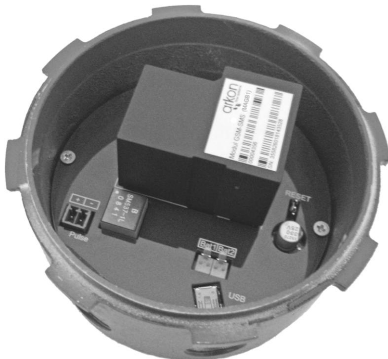
Imagen 3. Instalación del módulo GPRS/GSM en el transmisor
