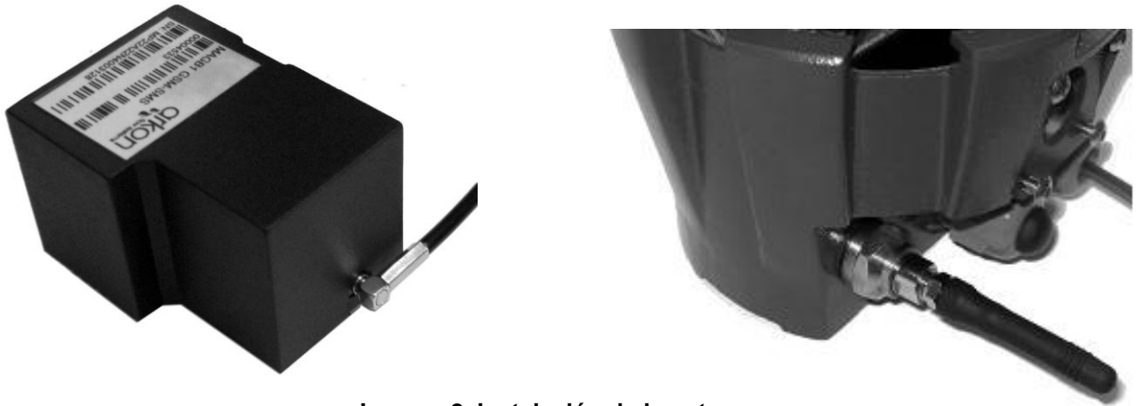
Imagen 2. Instalación de la antena
